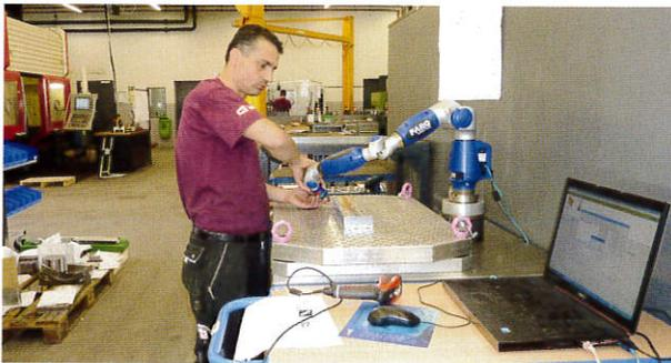
Mit Hilfe eines Faro Messarms wird das Bauteil direkt auf der Spannpalette vermessen.
