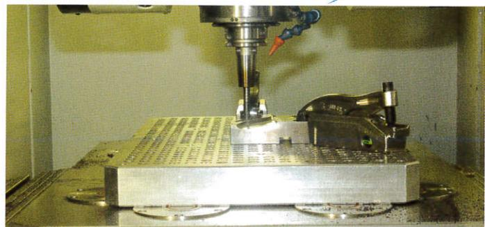
Perfekt vorbereitet: Die gerüsteten Paletten werden rund um die Uhr auf den Fräsmaschinen bearbeitet.
